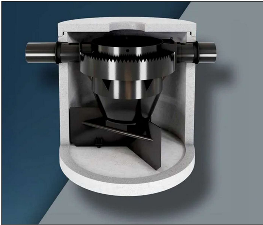
Abbildung 7: Prinzipbild Reinigungsschacht „hydroshark“
