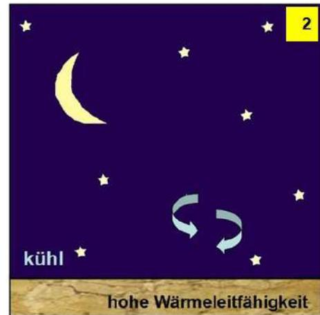
**Bild 2:** Wasser hat eine hohe Wärmeleitfähigkeit. Bei einem feuchten, grundwassernahen Boden führt dies zu geringerer Abkühlung der Luft, da die Bodenwärme besser an die Oberfläche geleitet werden kann als bei einem trockenem Boden.
