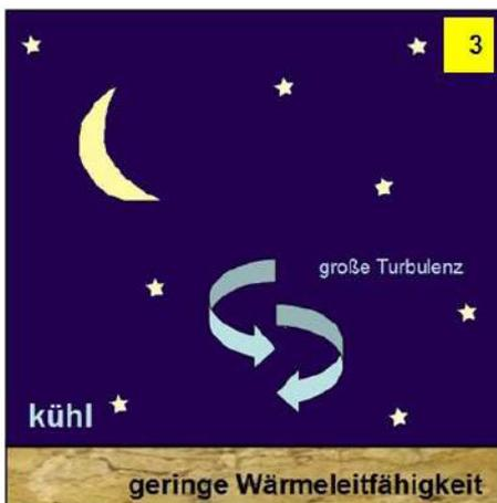
**Bild 3:** Daneben spielt aber auch die Intensität des Luftaustausches mit der Höhe (Turbulenz) eine Rolle, denn bei starker vertikaler Vermischung wird in der Höhe lagernde wärmere Luft zum Boden eingemischt und verhindert damit eine starke Abkühlung.
