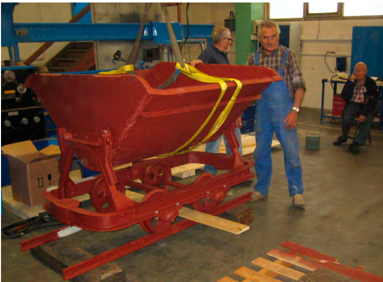
Diese Bergwerkslore wurde in Würm zur Erstellung des Luftschutzstollens und nach 1945 bei der Trümmerbeseitigung in Pforzheim eingesetzt.
