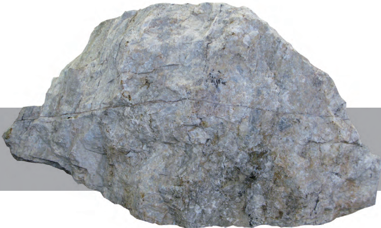
Der Schwerspatbrocken (Baryt) aus der Grube Liebenck I hat eine Außenhaut aus Eisenoxyd.
