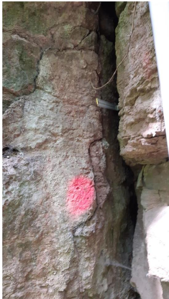
Abbildung 2: Felsspalte im nordöstlichen Steinbruchbereich mit eingeschobenem Zollstock.
