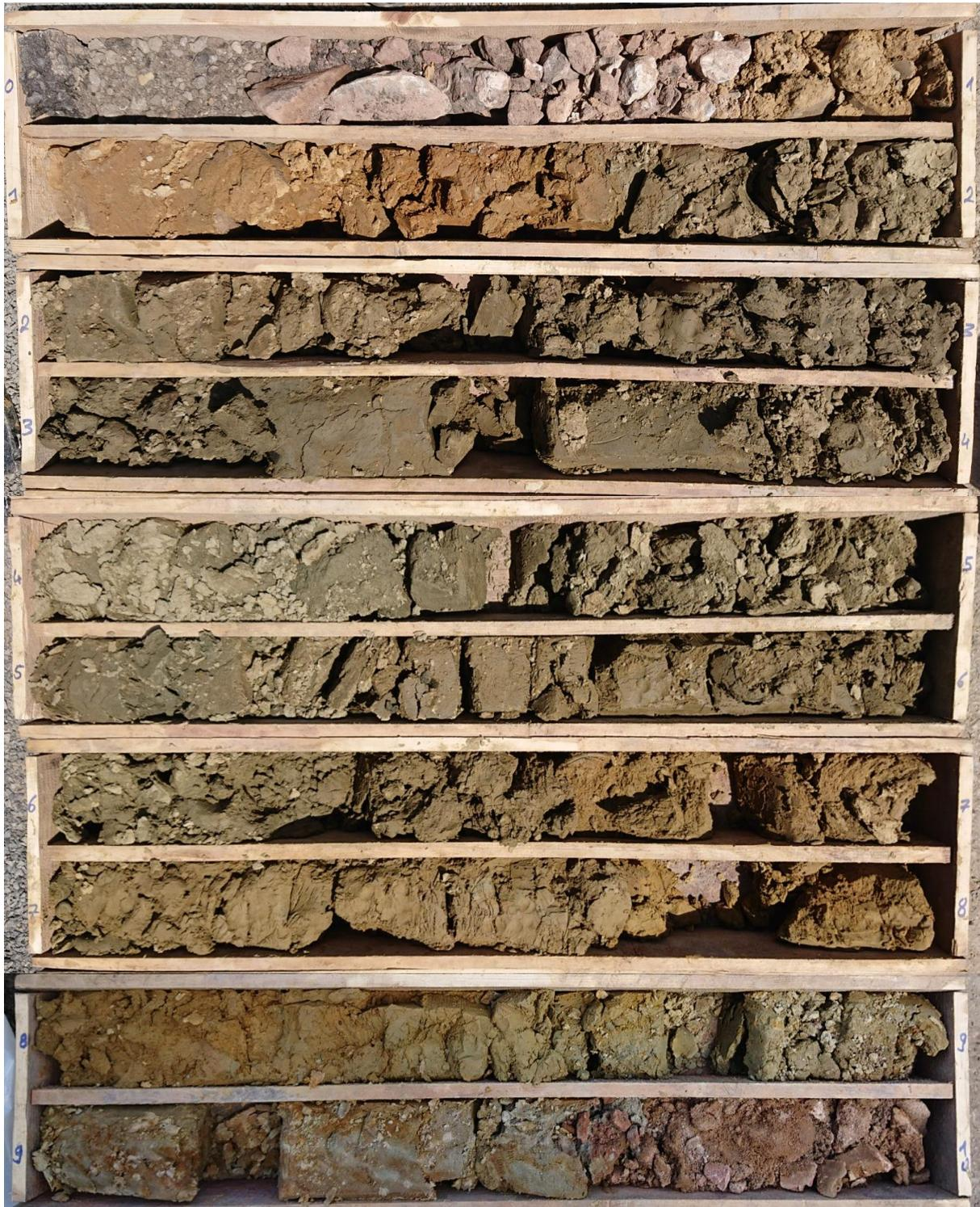
Fotodokumentation der Bohrung KB 1 (10,0 m - 15,3 m u. GOK)
