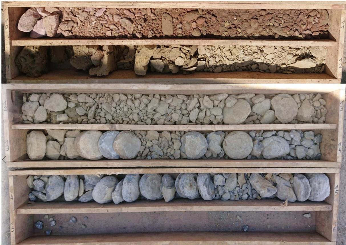
Fotodokumentation der Bohrung KB 3 (0,0 m - 10,0 m u. GOK)
