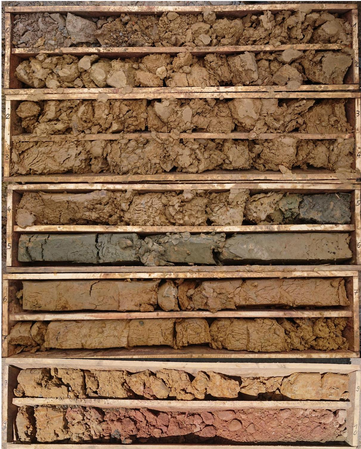
Fotodokumentation der Bohrung KB 2 (10,0 m - 15,0 m u. GOK)
