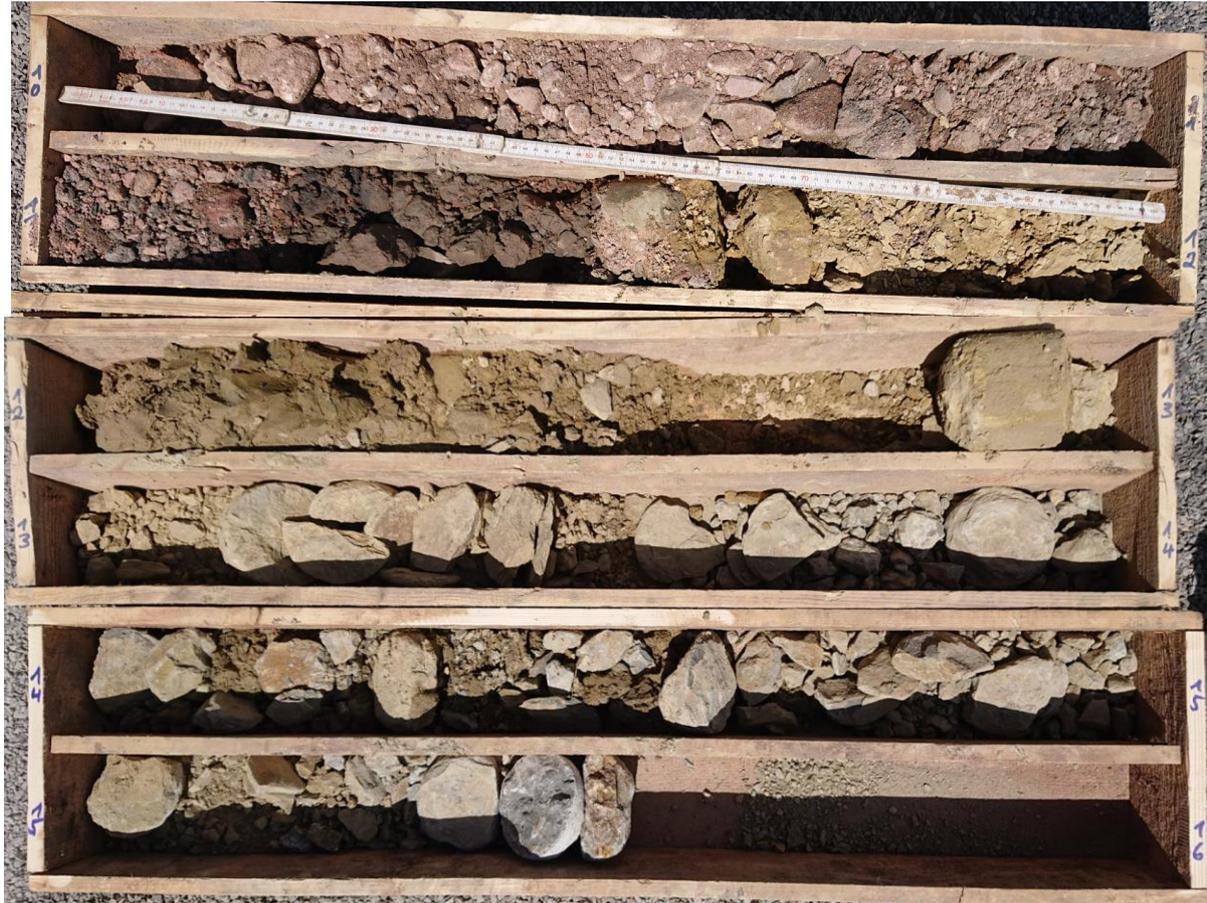
Fotodokumentation der Bohrung KB 2 (0,0 m - 10,0 m u. GOK)
