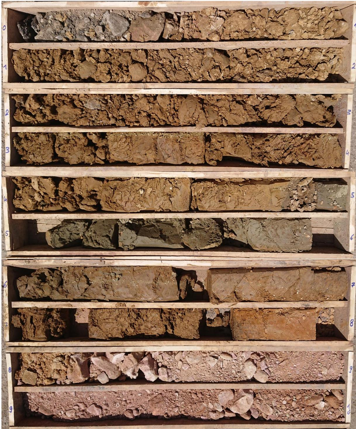
Fotodokumentation der Bohrung KB 3 (10,0 m - 16,0 m u. GOK)
