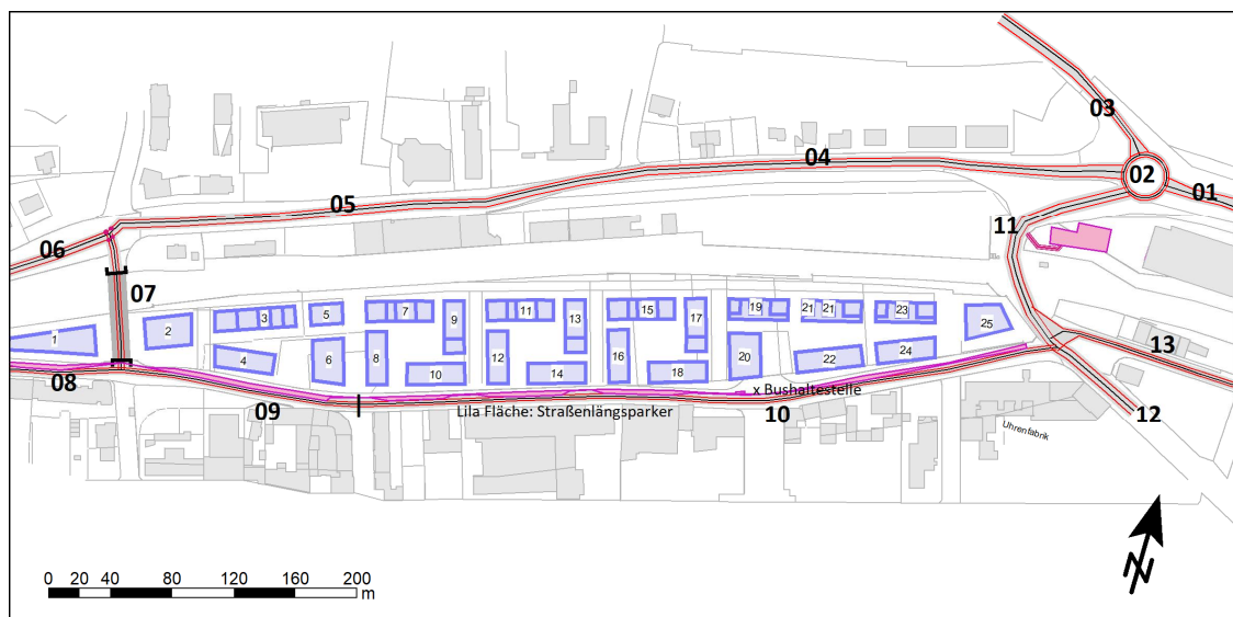
Abb. 02: Querschnitte für Straßenlärm Berechnung
