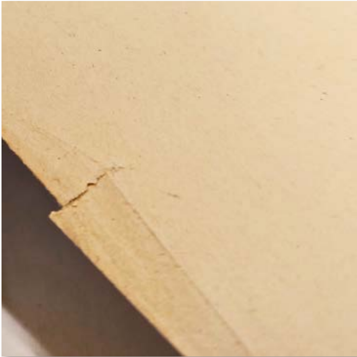
Abb. 9: Das Papier ist stark vergilbt und wird an den Rändern brüchig. Die Risse zeigen, dass es schon instabil geworden ist (Stadtarchiv Pforzheim, B30-546, Foto: Stadtarchiv Pforzheim)
