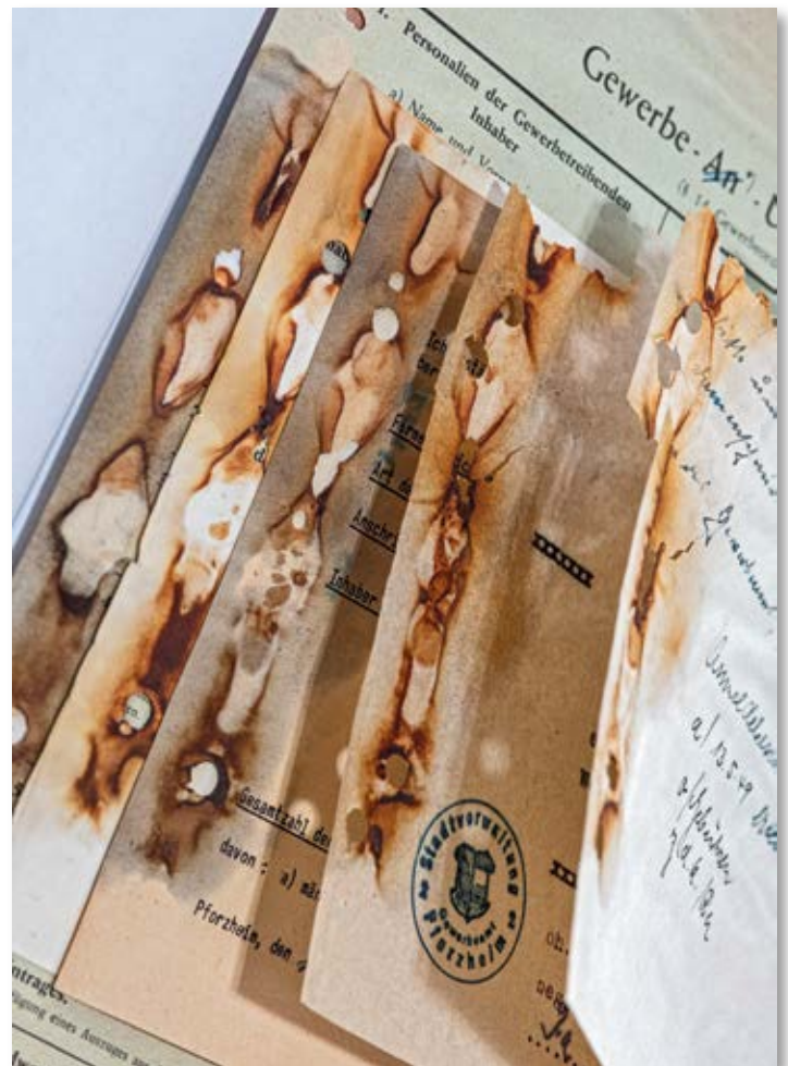
Abb. 8: Bei dieser Gewerbeakte hat sich der Rost eines oxidierten Heftbügels durch mehrere Blätter gefressen (Stadtarchiv Pforzheim, B32-373, Foto: Heiko Rudek)
